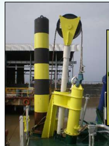
Spud hoisting and spuds
